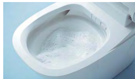
最初に直径約5mmのミリバブルで大きな汚れを除去。次に直径約60μmの洗剤マイクロバブルで小さな汚れも除去(洗剤マイクロバブルの出荷時の設定は大洗浄のみとなっております)。
